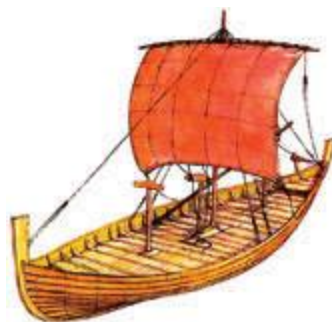
◆ Рис. 8. Кнорр — 16-метровое судно норманнов. С 20 тоннами груза оно погружалось в воду лишь на 1,3 метра
